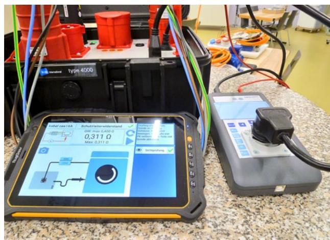
**[FIG. 1]** Contrôle d'appareil selon la norme SNR 462638 (source : as-energie GmbH).
